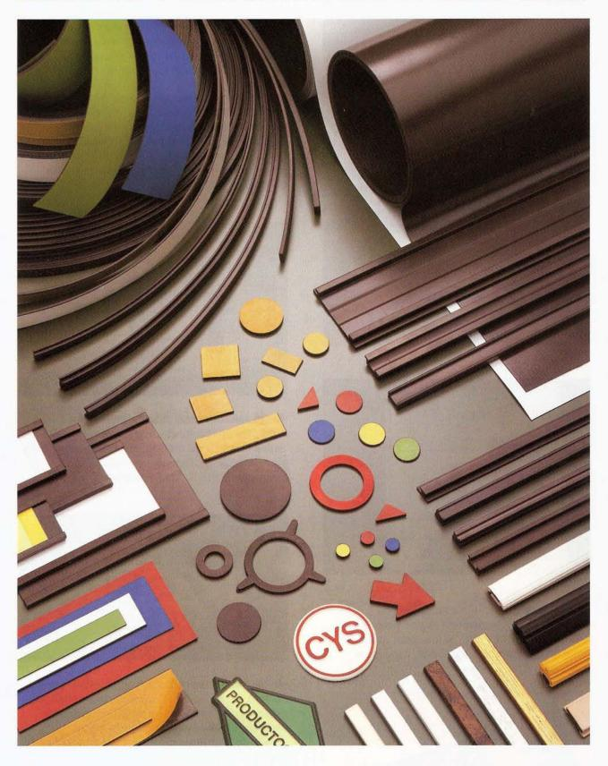
FERRIPLÁS es un producto magnético permanente y flexible. Está formado por finas partículas de ferrita dura BaO x 6 Fe<sub>2</sub> O<sub>3</sub> o SrO x 6 Fe<sub>2</sub> O<sub>3</sub> aglomeradas mediante un elastómero ligante: caucho, cloruro de polivinilo, hypalon u otro material plástico.
